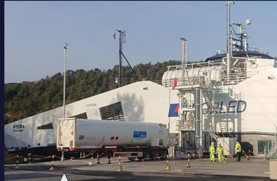
Norled Hydra LH2 bunkering - 3 tonnes/hour
